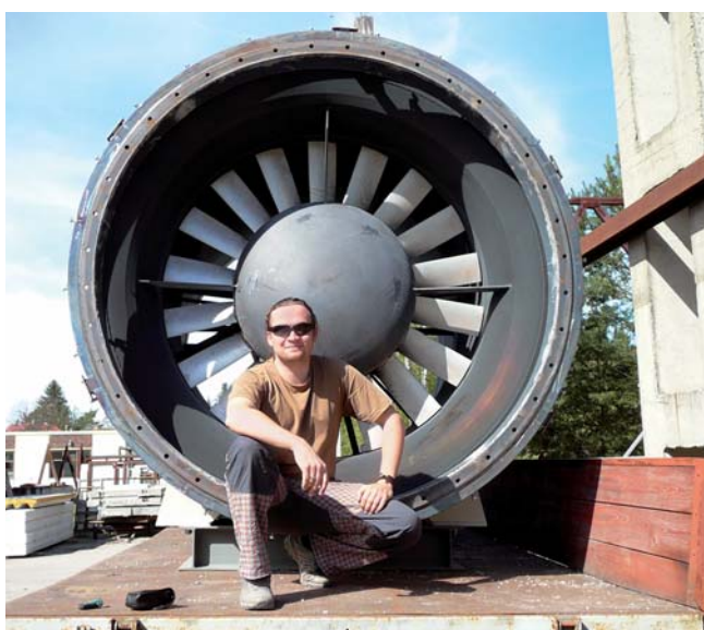
Jako nový vypadá ventilátor APH 2800 po ostré zkoušce ve zkušebně PAVUS, kde odolal i teplotě 400 stupňů Celsia. Na snímku s ním je zachycen konstruktér Marián Humený.
