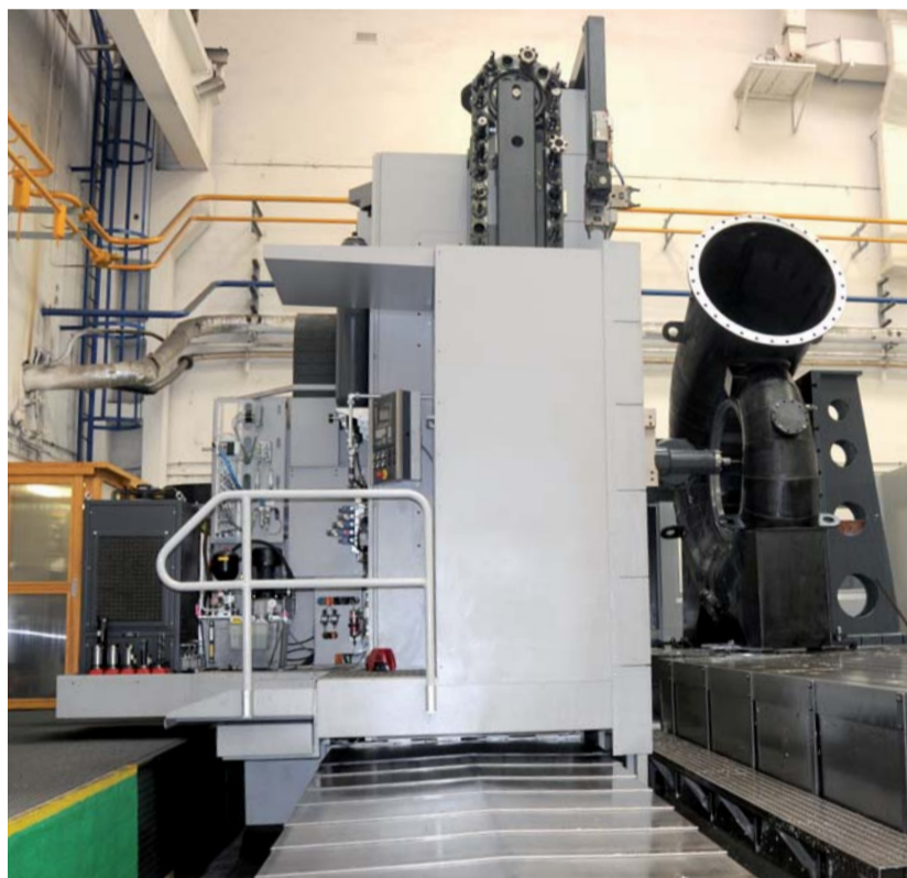
CNC centrum. Součástí kooperačních zakázek, které doplňují využití výrobních kapacit, se stala spirální skříní Francisovy turbíny pro společnost Hydrohrom Strženeč.
