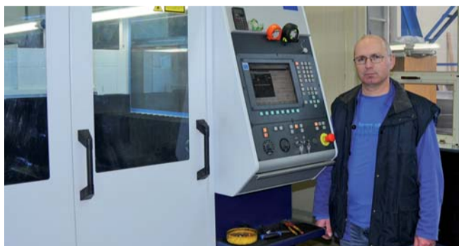
Nový stroj TRULASER L3060 na pálení plechů o rozměrech až 6 x 2 metry.
