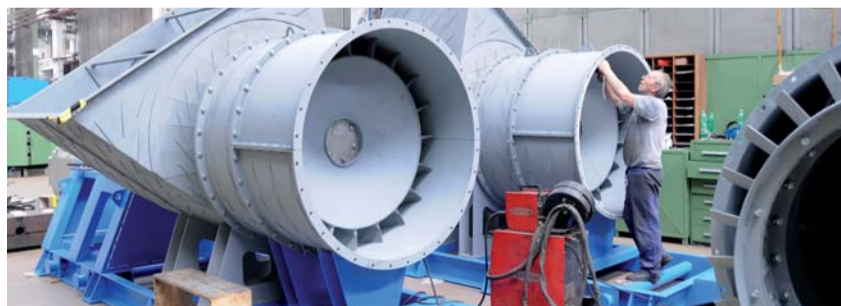
Montáž šesti axiálních rovnotlakých ventilátorů ARM - D 1400 mm, které budou umístěny v Elektrárně Opatovice. Odběratelem je slovenská společnost SES Tlmače.
