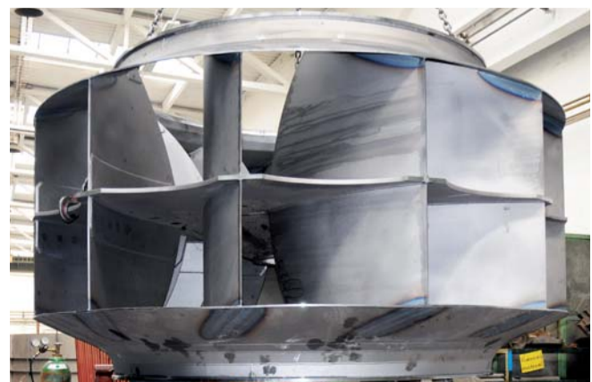
Pro německou společnost KHD - Humboldt WEDAG se vyrábělo radiální oběžné sací oboustranné kolo o průměru 3160 mm. Určeno je pro zakázku Sengilej v Ruské federaci.
