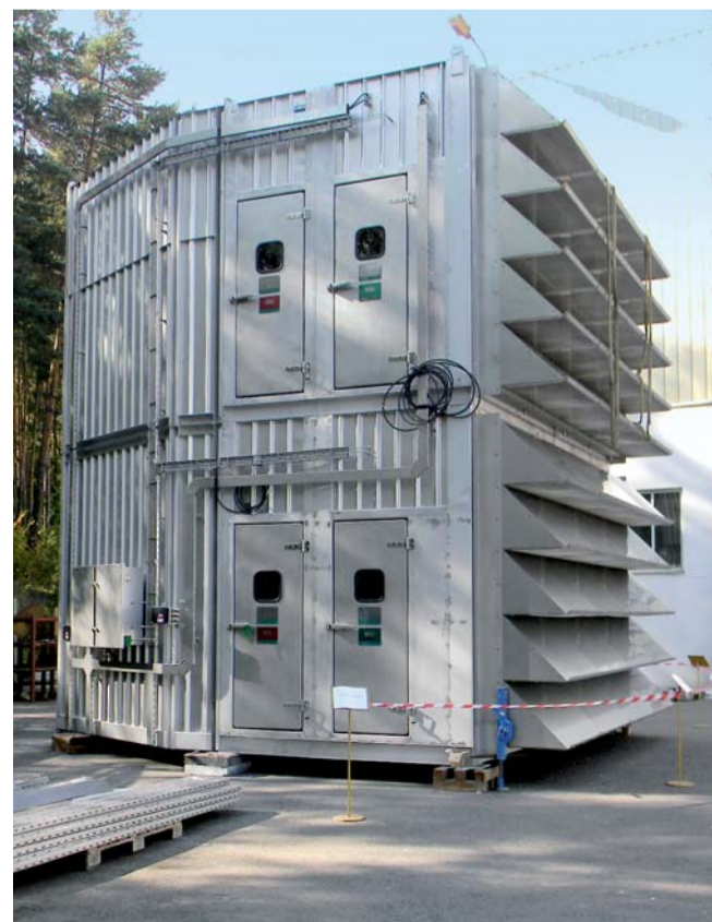
Filtrační modul pro stanice na ropné plošině po montáži na firemním dvoře
