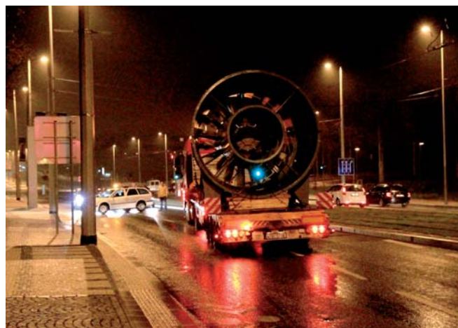
Speciální tahač veze noční Prahou ventilátor APH 2800 do větracího objektu Špejchar na Letné. Transport si vyžádal i zastavení dopravy, neboť bylo třeba najíždět v protisměru
